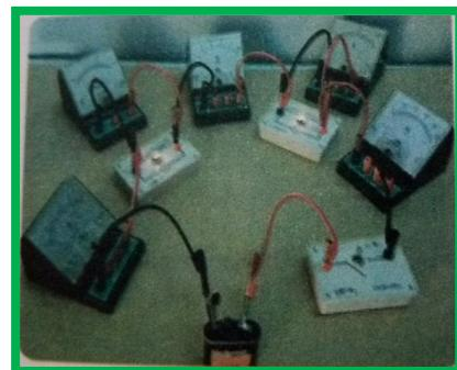
7. اربط مصابيحين على التسلسل في دارة كهربائية ثم قس شدة التيار الكهربائي في عدة نقاط و التوتر الكهربائي بين عدة نقاط في هذه الدارة الكهربائية.
